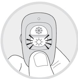
Drücken Sie die Heiztaste an der Fernbedienung, um zwischen Ein / Aus umzuschalten.
