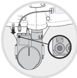
Verbinden Sie das Akkukabel mit der mit dem Akkusymbol gekennzeichneten Steckdose.
