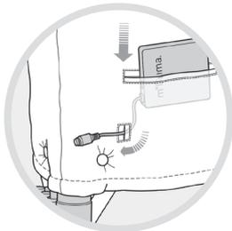
Stecken Sie die Batterie in die hintere Westentasche. Ziehen Sie das Batteriekabel durch das Loch an der Unterseite der Tasche heraus.
