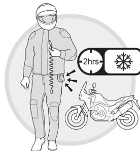
Wenn das System an die Batterie angeschlossen ist, können Sie die Kühlung für 2 Stunden nutzen.
