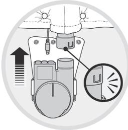
Befestigen Sie die Gebläseeinheit an der Trägerplatte, indem Sie die Klettverschlüsse durch die Schlitze ziehen. Verbinden Sie die Gebläseeinheit mit dem Luftpfeifen der Weste. Verbinden Sie die Befestigungsschrauben der Gebläsestütze mit der Weste.
