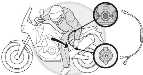
Verbinden Sie die Gebläseeinheit mit dem für diesen Zweck mitgelieferten Kabel mit dem Fahrzeug. Bei Fahrzeugantrieb können sowohl Heiz- als auch Kühlsysteme einzeln aktiviert werden. Bei Batteriebetrieb kann nur das Kühlsystem aktiviert werden.
